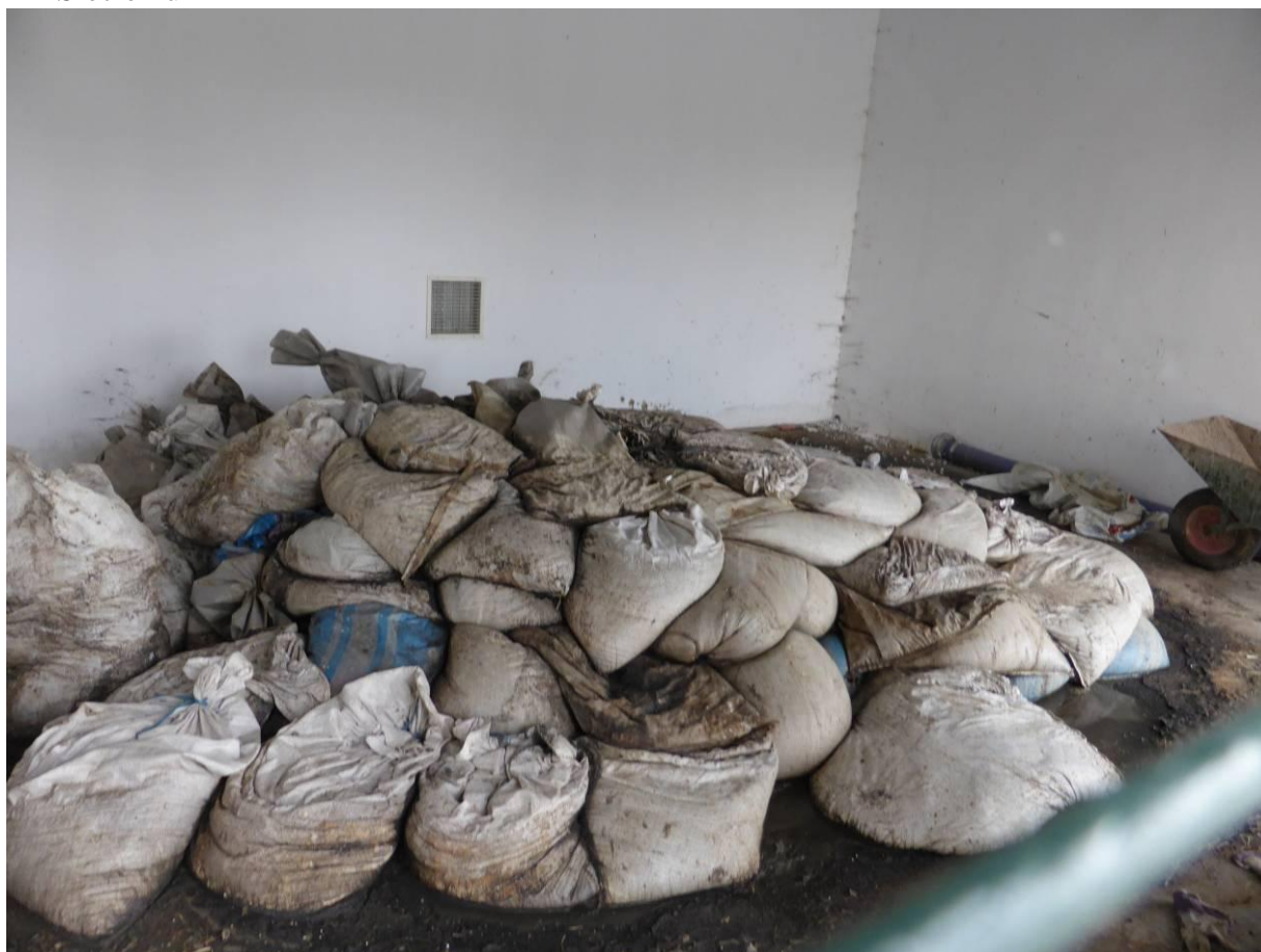
Fot. nr 10 . Urządzenie do odwadniania osadu typ DRAIMAD w oczyszczalni ścieków w Siecieniu
